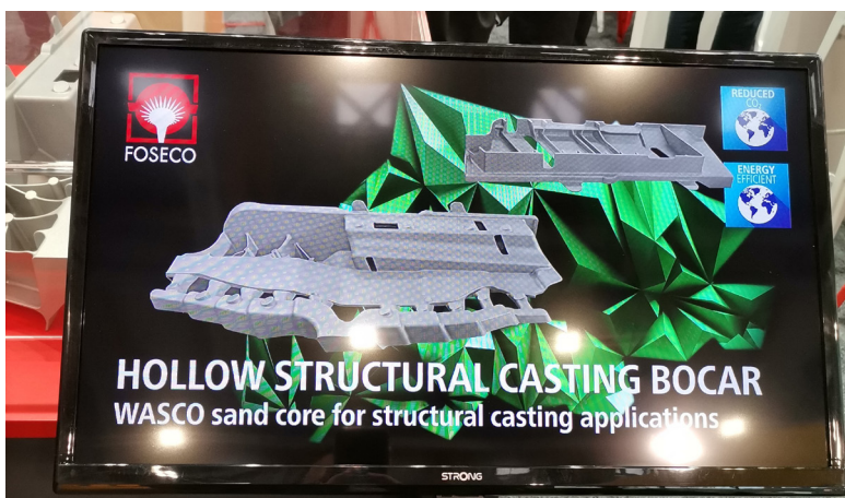
Velmi zajímavé použití pískového jádra při vysokotlakém lití
