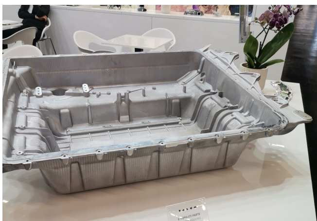
Rovněž velmi často zastoupený odlitek – skříň pro baterii do elektromobilu
